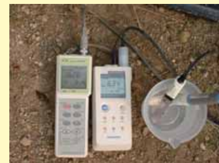
(左)電気伝導計、(右)p.H計 水質の変化を監視しています。
