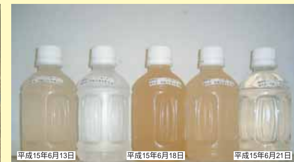
平成15年6月13日 平成15年6月16日 平成15年6月18日 平成15年6月19日 平成15年6月21日 G/L: 108.75m G/L: 107.47m G/L: 108.02m G/L: 110.29m G/L: 109.26m E.C.: 24.0mS/m E.C.: 28.8mS/m E.C.: 26.0mS/m E.C.: 23.9mS/m E.C.: 23.8mS/m p.H: 7.4 p.H: 7.1 p.H: 7.3 p.H: 7.3 p.H: 7.3 水温: 15.6 水温: 13.5 水温: 14.8 水温: 15.9 水温: 15.6
