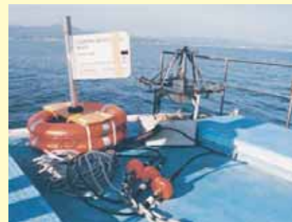
(右) エクマン・バージグラブサンプラ (採泥器) (左) 多目的水質計 多目的水質計は水温、電導度、DO、p.H、濁度、クロロフィル、アンモニア、硝酸、塩素などを測定する機能がついています。
